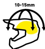
Le système de sécurité Mips® consiste en une couche à faible coefficient de frottement placée à l'intérieur d'un casque de motocross qui permet un mouvement multidirectionnel de 10 à 15 millimètres lors de certains chocs obliques et qui vise à réduire la force rotationnelle transmise à la tête.
