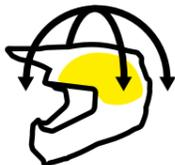
Le système de sécurité Mips® consiste en une couche à faible coefficient de frottement placée à l'intérieur d'un casque de motocross qui permet un mouvement multidirectionnel de 10 à 15 millimètres lors de certains chocs obliques et qui vise à réduire la force rotationnelle transmise à la tête.
